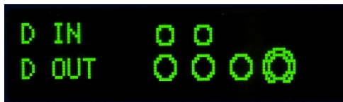
Figura 3-18: Schermata del test I/O discreto, con uscita attiva (in basso)
