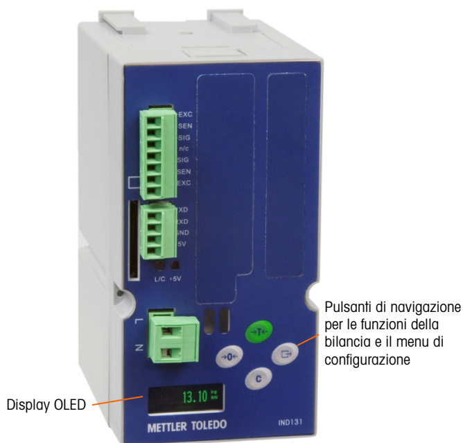
Figura 1-8: layout del pannello anteriore di IND131
